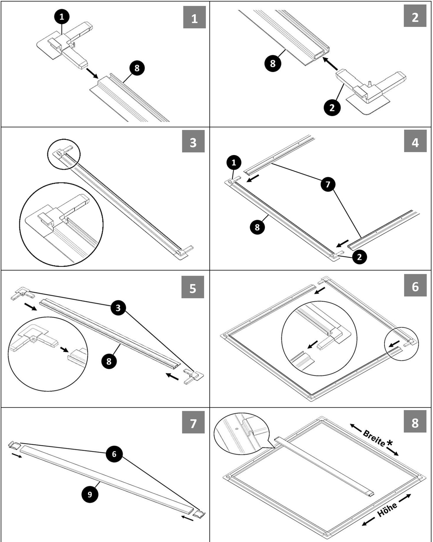
\* Rollobreite > Rollohöhe, so wird die Mittelsprosse vertikal montiert.
